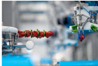
Mit dem Pick & Skewer kann ein einziger Mitarbeiter pro Stunde bis zu viertausend Fleischspieße aus jeweils dreizehn Bestandteilen produzieren. Pintro - Bild: Pintro
